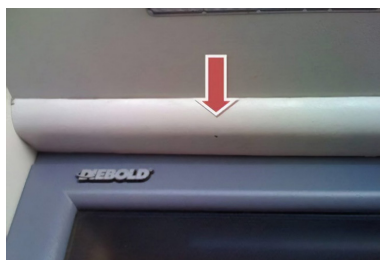
Рис. 58. Камера в фальш-панели под козырьком
