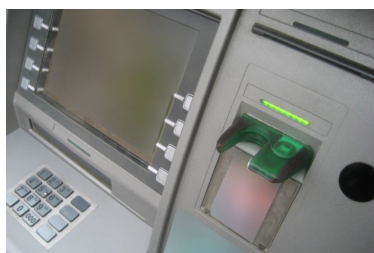
Рис. 55. Лже-антискиммер замаскирован под прозрачный антискиммер, содержит считывающее устройство внутри картоприемника
