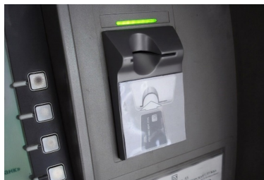
Рис. 53. Скиммер, содержащий считывающее устройство внутри накладного картоприемника
